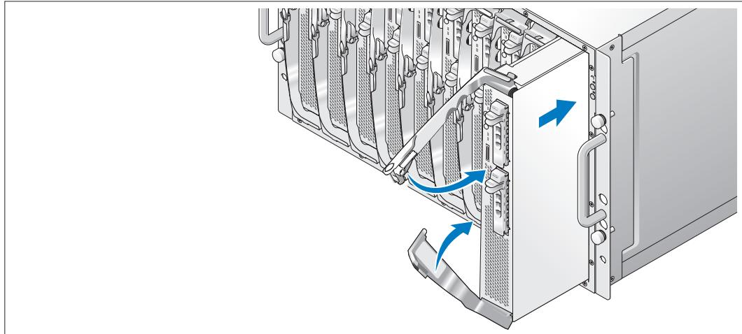
De izquierda a derecha, inserte los módulos en el chasis. Cuando las asas abiertas entren en contacto con el panel frontal del chasis, empiece a cerrarlas a la vez (el asa inferior se cerrará primero) hasta que el asa inferior esté alineada con el panel frontal del chasis. Siga bajando el asa superior hasta que esté alineada con el asa inferior. Cuando las asas estén totalmente cerradas, el pestillo de liberación fijará las dos asas al panel frontal.
