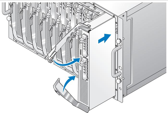
Começando da esquerda para a direita, deslize os módulos para dentro do chassi. Quando as alças abertas tocarem o painel frontal do chassi, gire-as simultaneamente (a alça inferior fechará primeiro) até que a alça inferior fique rente ao painel frontal do módulo. Continue a girar a alça superior para baixo até que fique rente à alça inferior. Quando as alças estiverem completamente fechadas, a trava de liberação prenderá as duas alças ao painel frontal.
